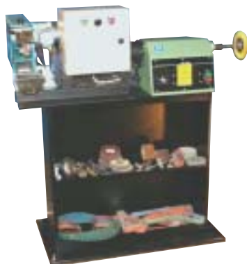
Variable speed mini belt plus variable speed mini buff, 500-5,000 rpm
