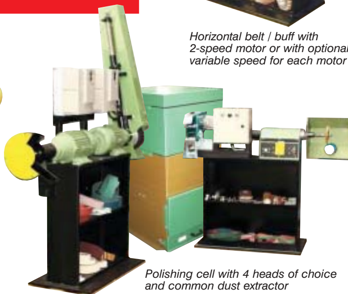
Variable speed mini belt plus variable speed mini buff, 500-5,000 rpm
